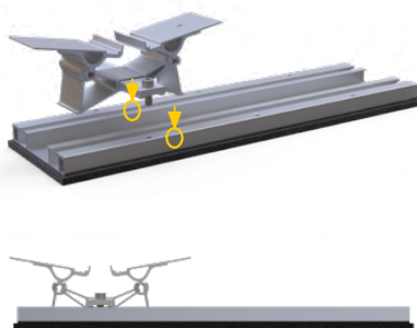
Montage der Doppelstütze klein – kurzer Abstand
