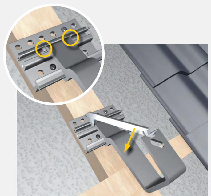
Dachhaken mit dem Biegewerkzeug sichern
