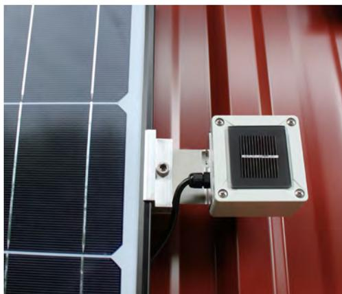
Le Spektron 320 est fixé à l'aide de son support sur la structure de montage de l'installation photovoltaïque. Bien prendre soin que le capteur aie la même inclinaison et la même orientation que l'installation à contrôler. Le moindre écart peut être à l'origine d'erreurs de mesure!
