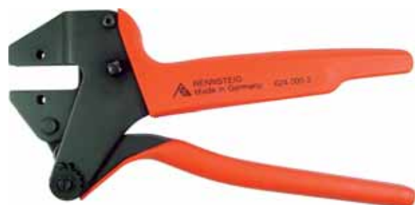
Die Rennsteig Crimpzange PEW 12 eignet sich durch ihre verschiedenen Crimpeinsätze für mehrere Steckverbinder-systeme.
