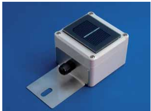
Le Spektron 310 peut émettre quatre signaux normalisés différents vu qu'il dispose d'une platine d'amplificateur de mesure intégrée. Cette platine doit être alimentée avec 5 à 30 V CC ou 12 à 30 V CC.
