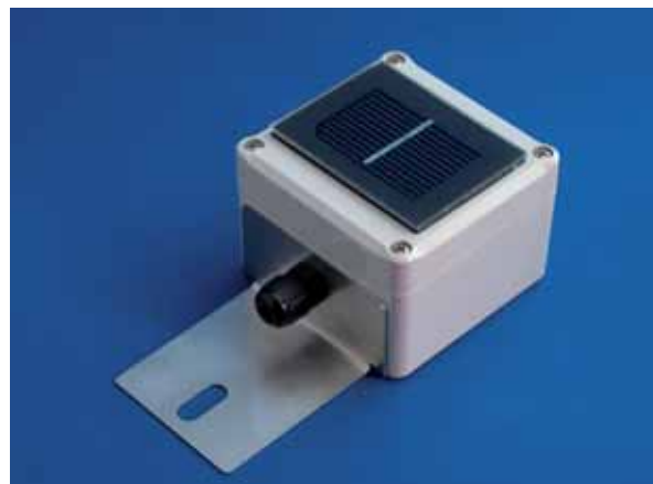
Der Spektron 310 kann vier verschiedene Normsignale ausgeben, da er über eine integrierte Messverstärkerplatine verfügt. Diese Platine muss mit 5 bis 30 V DC oder 12 bis 30 V DC versorgt werden.
