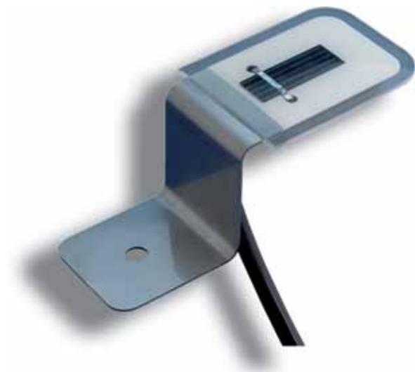
Spektron 210: Das Anschlusskabel ist 2-adrig und UV-beständig. Alle Spektrens werden unter einem Sonnenlichtsimulator gegen einen vom Fraunhofer ISE kalibrierten Referenzsensor kalibriert.
