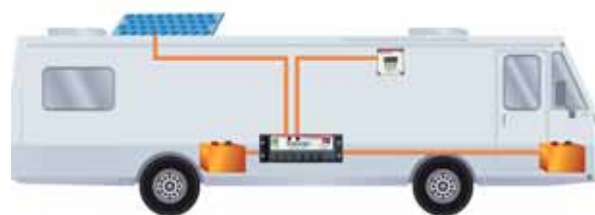
Der SunSaver Duo eignet sich gleichzeitig sowohl zur Ladung der Bord- als auch der Starterbatterie.
