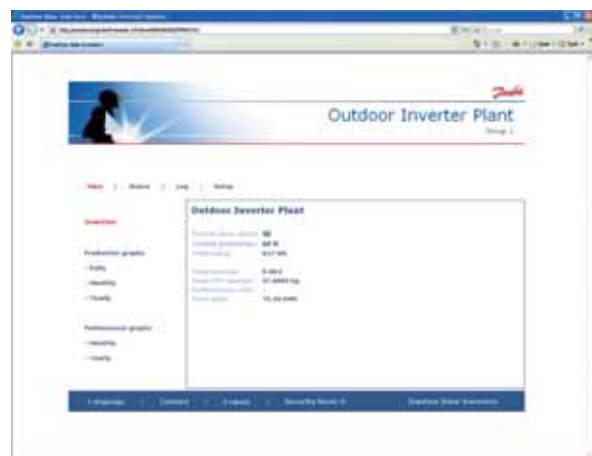
Gli inverter TripleLynx sono disponibili come opzione nel modello Plus (incl. compensazione della potenza reattiva) e nel modello Pro (incl. web server).
