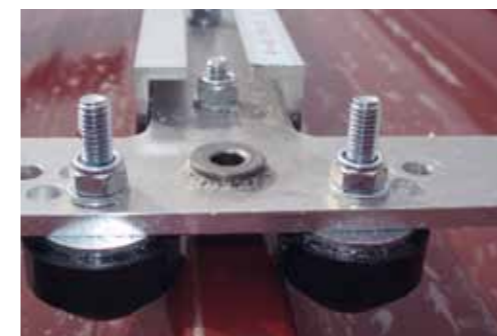
Ajustar los pernos de apoyo
