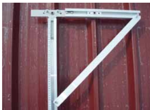
Montaje del patrón para taladrar TRI-VENT con 6 tornillos
