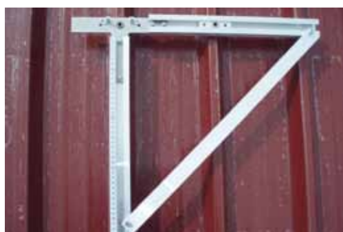
Montaje del patrón para taladrar TRI-VENT con 6 tornillos
