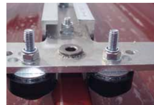
Ajustar los pernos de apoyo
